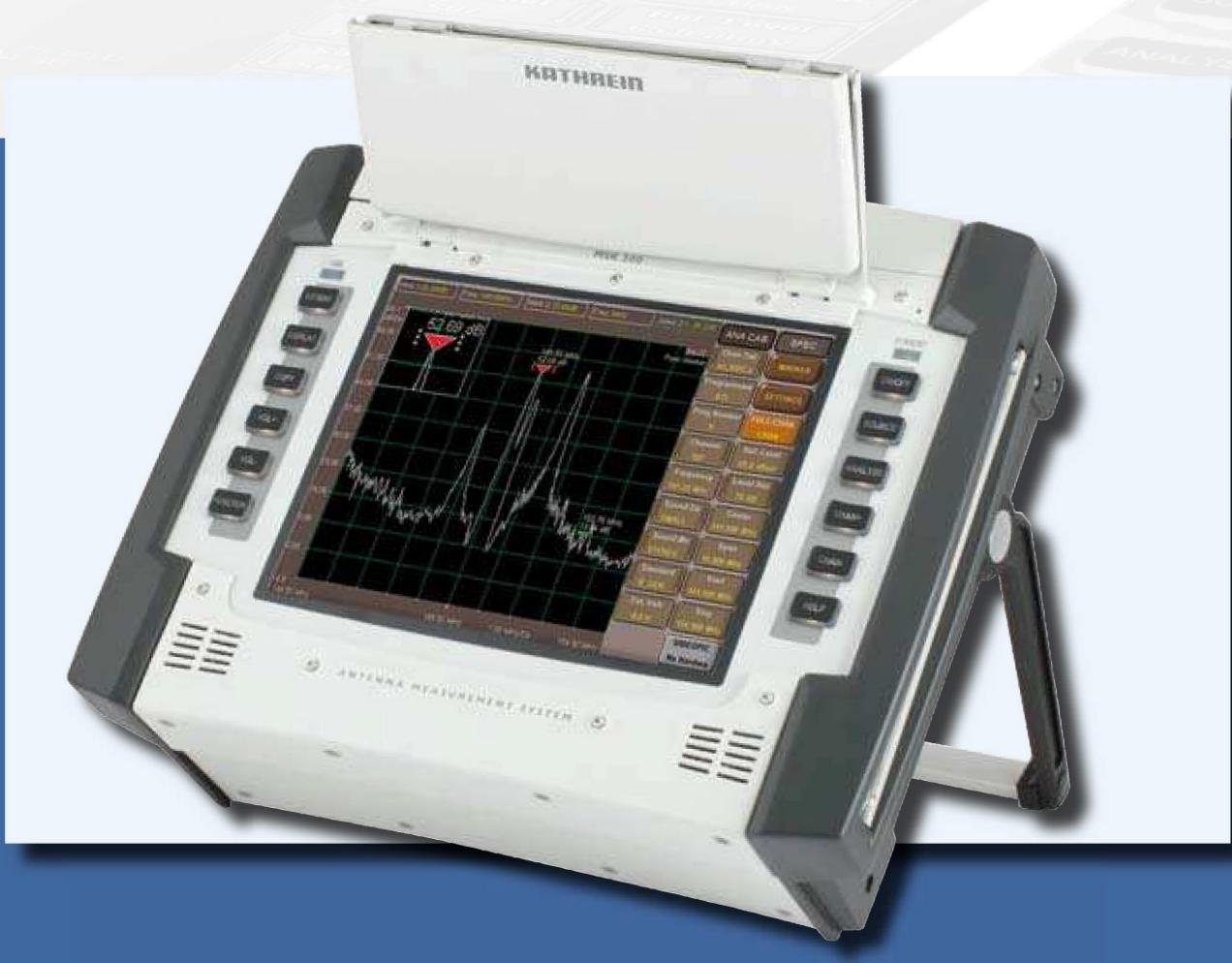
Измеритель сигналов MSK 200 последнего поколения, выполненный в компактной конструкции, позволяет выполнять полный набор проверок антенных или кабельных систем, а также головных узлов сетей.
